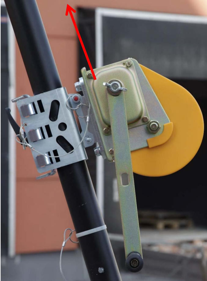
Rysunek 2 – Dopuszczalny kierunek obciążenia
