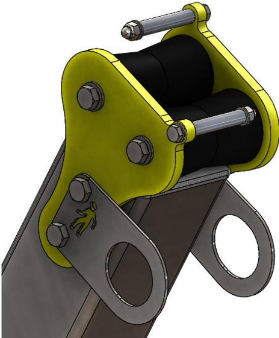
Figura 6 – Guiado del cable de trabajo del dispositivo fijado en el extremo a través de la polea.
